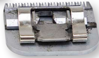
Links die Scherplatte mit Schnellwechselsystem der Favorita Cli von Aesculap, unten das SnapOn-Wechselsystem der anderen drei Schermaschinen.
